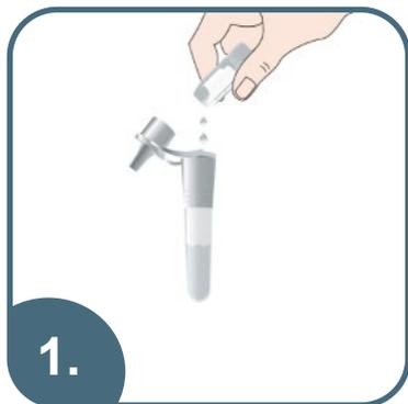
**1.** Befüllen des Extraktionsröhrchens mit der Extraktionslösung.
